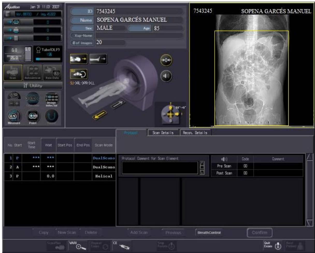
Figura 15-19). Sobre la imagen del Topograma abdominal, realizado en proyección anteroposterior, se traza el recuadro del FOV que indica los límites superior e inferior de una adquisición helicoidal de rutina del abdomen. Toshiba Aquilion 64 (HUMS) .
