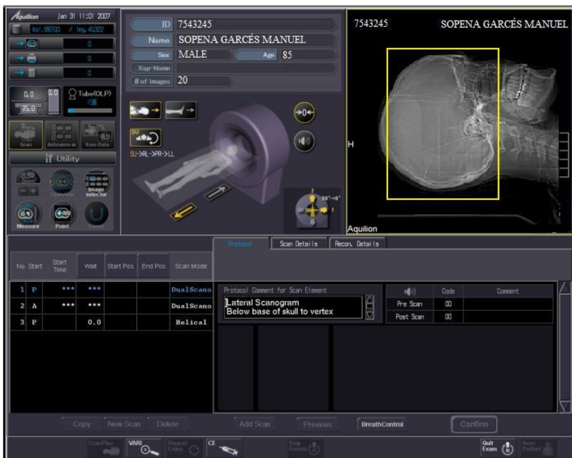
Figura 15-13). El recuadro trazado por el Técnico sobre la imagen del cráneo delimita los contornos de una adquisición 3D. Toshiba Aquilion 64 (HUMS).
