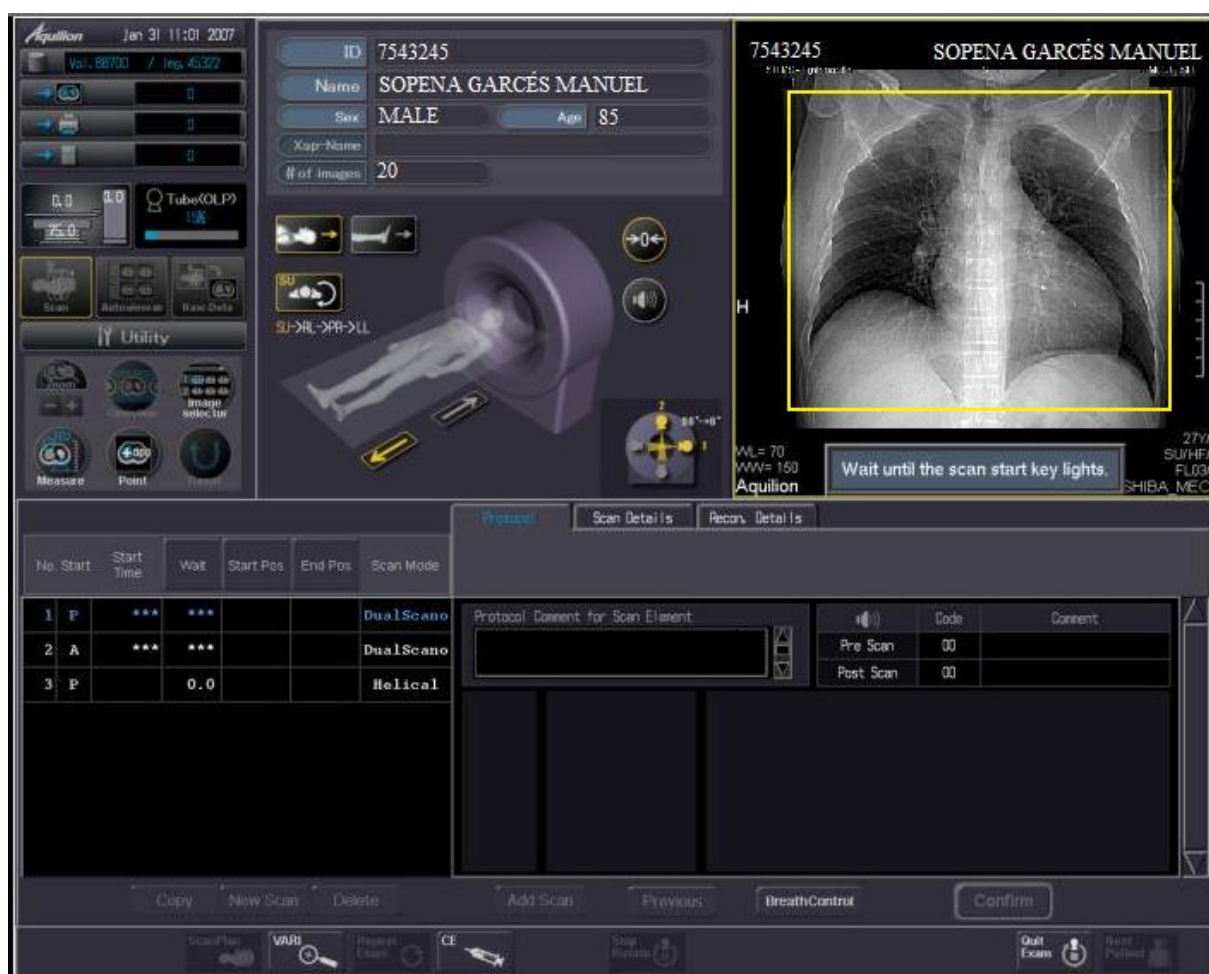
Figura 15-14). Sobre la imagen del Topograma, en proyección anteroposterior, se traza el recuadro del FOV. Toshiba Aquilion 64 (HUMS).
