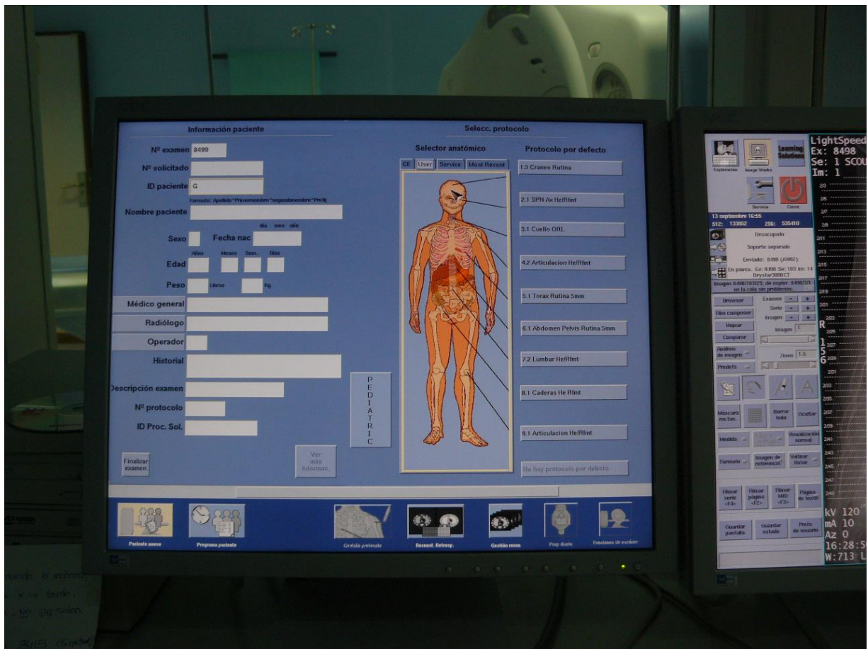
Figura 15-5) Vista panorámica de la Interfaz de Usuario, del monitor de adquisición de datos de un modelo LightSpeed de GE (HUMS) . El Diseño varía completamente aunque las funciones son las mismas. A la izquierda de la pantalla aparecen una serie de casillas en blanco para anotar los datos identificativos del paciente. A la derecha se puede apreciar el icono para seleccionar los protocolos.
