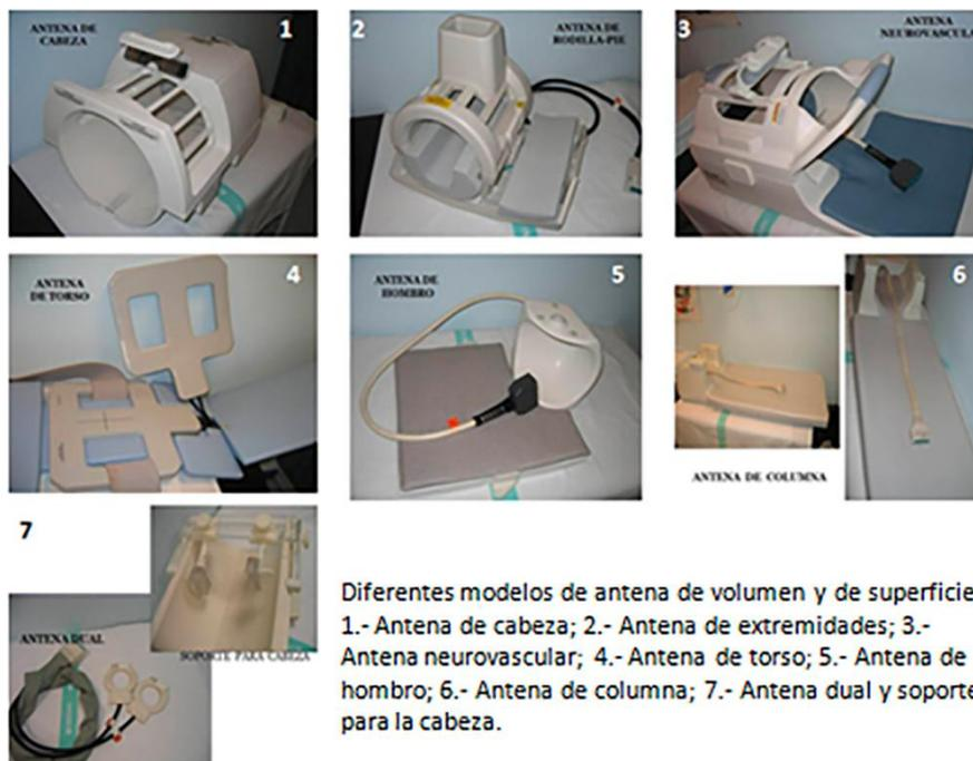
En lo relativo a la forma, las antenas suelen clasificarse en antenas de volumen y antenas de superficie.
