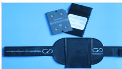
FIG. 4. Componentes del dosímetro de muñeca TLD.
