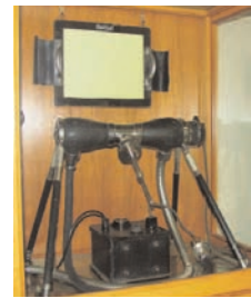
Equipo de rayos X con tubo Philips Metalix, en la sede de Philips en Madrid
